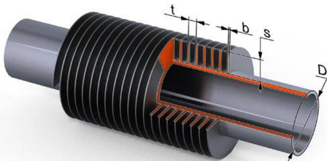
Компания «РОССЭН» производит спирально-оребрённые стальные трубы, изготовленные методом непрерывной радиочастотной сварки. Технология изготовления спирально-оребрённых труб заключается в соединении гладкой трубы и стальной ленты, нагретых высокопроизводительной установкой ТВЧ до сварочной температуры. В точке схождения под действием приложенного извне усилия происходит деформация и приварка ленты к трубе. Исходная ширина ленты после сварки
